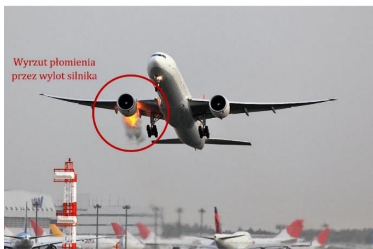
Rys. 1.10. Przykład wystąpienia pompażu silnika w trakcie wznoszenia samolotu [122]
