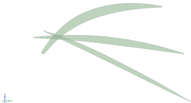
Rys. 5.21. Profile łopatki wirnika pierwszego stopnia w rzucie z góry
