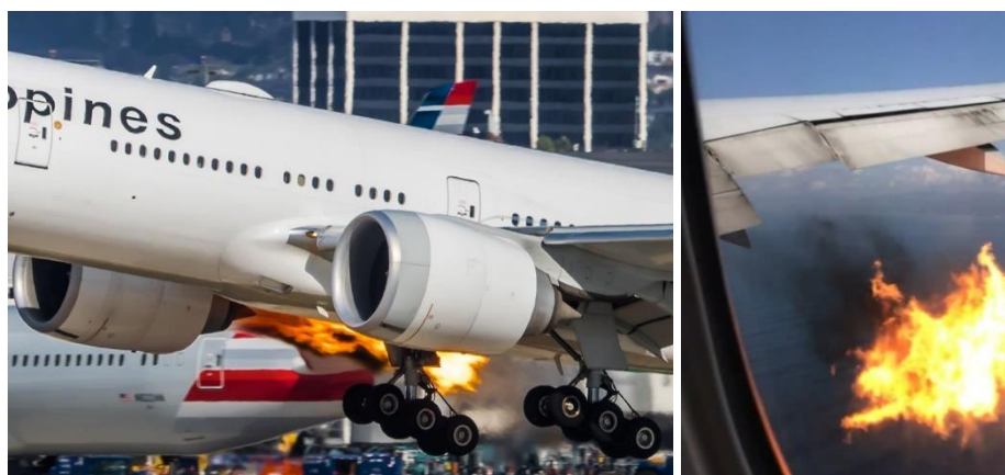
Rys. 1.13. Pompaż silnika na samolocie Boeing 777-300 Philippine Airlines lot PR113 LAX-MNL 21.11.2020 [125]
