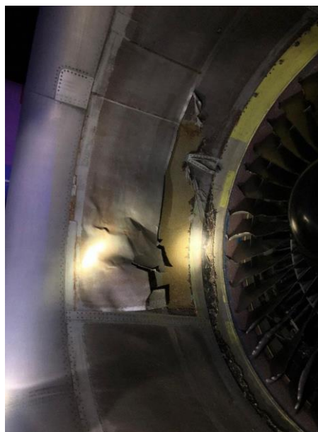
Rys. 1.11. Uszkodzenie układu wlotowego w wyniku pompażu po starcie - Boeing 767 Air Canada lot AC837 MAD-YYZ 03.02.2022 [123]
