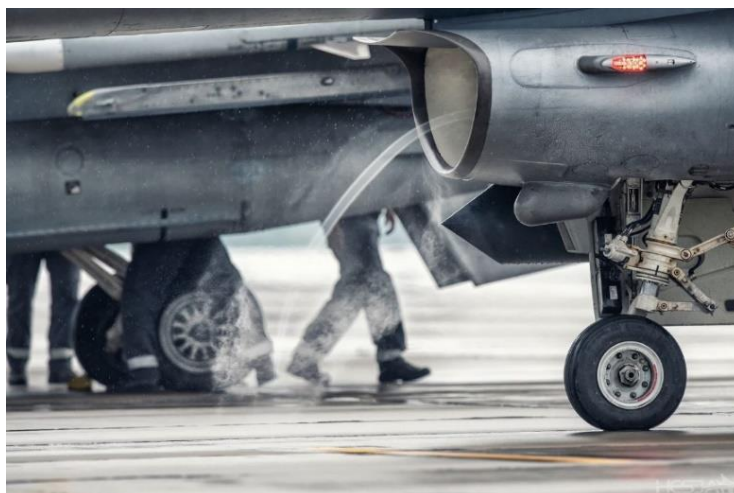
Rys. 2.11. Wir wlotowy w układzie wlotowym samolotu F-16 [131]
